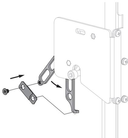
1. Dévissez le boulon de fixation et retirez l'ancien fusible. Fixez un côté du nouveau fusible sur le crochet, puis l'autre côté avec le boulon.
