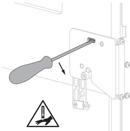
1. Pour déclencher le mécanisme et entraîner la chute de la lame, insérez un tournevis dans l'ouverture du mécanisme et effectuez un mouvement de levier.
