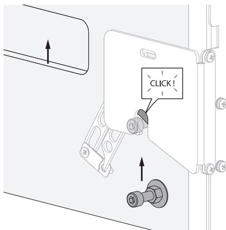
1. Faites glisser la lame en la soulevant par les 2 poignées jusqu'à ce que le boulon s'emboîte dans la serrure ouverte.
