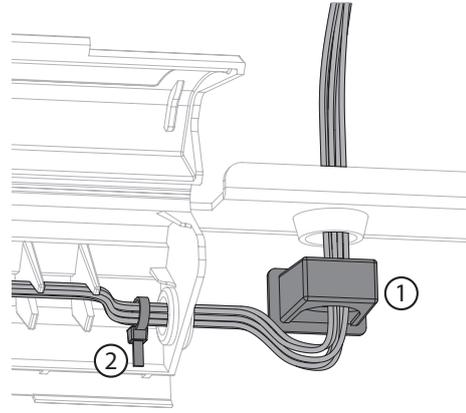
2. Faites passer les câbles par l'ouverture. Utilisez le clip de fixation (1) et le collier serre-câble (2) pour fixer les câbles dans le boîtier de raccordement et raccordez selon le schéma de raccordement.
