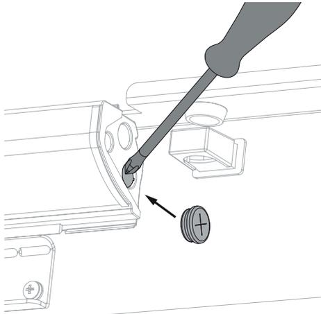
1. Percez l'ouverture dans la boîte de raccordement. Montez le passe-fil livré avec le produit.
